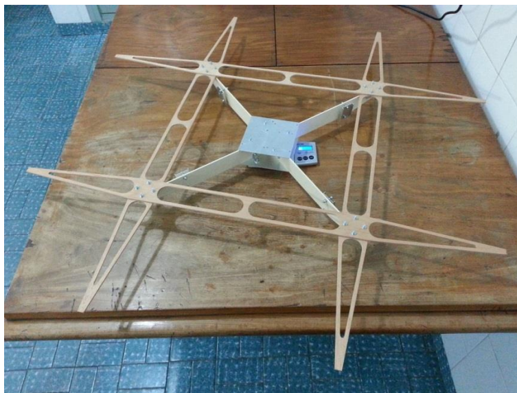
Figura 25.5 – Estrutura sem os componentes eletrônicos sendo pesada
